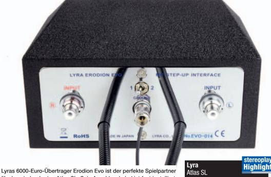
für das niederohmige Atlas SL. Sein Anschlusskabel ist fest installiert und vermeidet so Verluste durch Steckverbinder.
