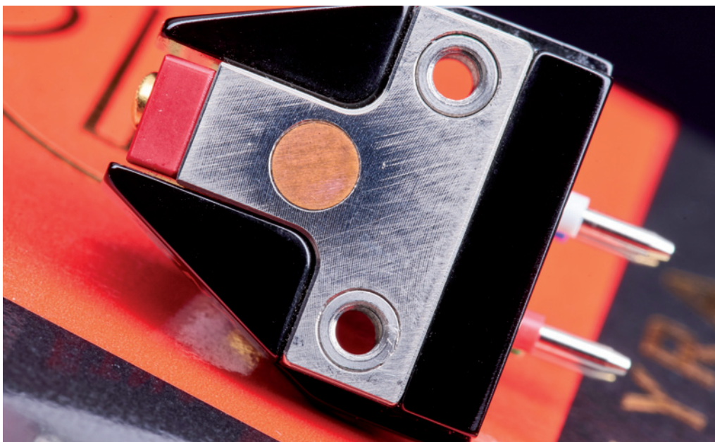
Nur über den Titankern nimmt das Etna Kontakt zum Headshell auf. Der eingelassene Bronzestab wirkt der Ausprägung von Material-typischen Resonanzen im Titan entgegen
