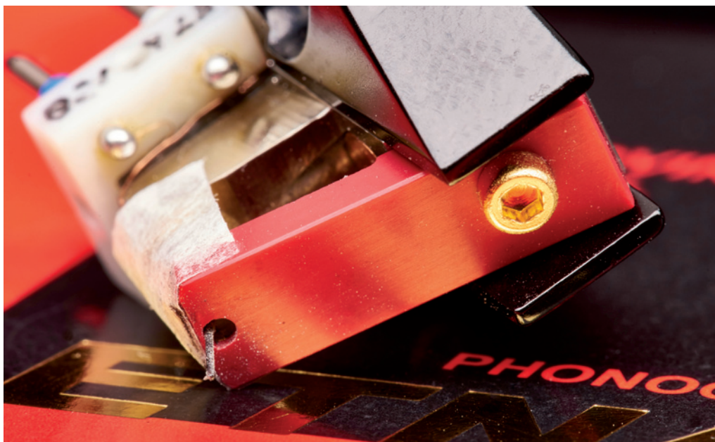
Der Generator des Etna kommt ohne Polstücke aus. Vor und hinter den Spulen befindet sich ein Scheibenmagnet. Informationen über das rote Material, in das der Frontmagnet eingelassen ist, gibt Lyra nicht
