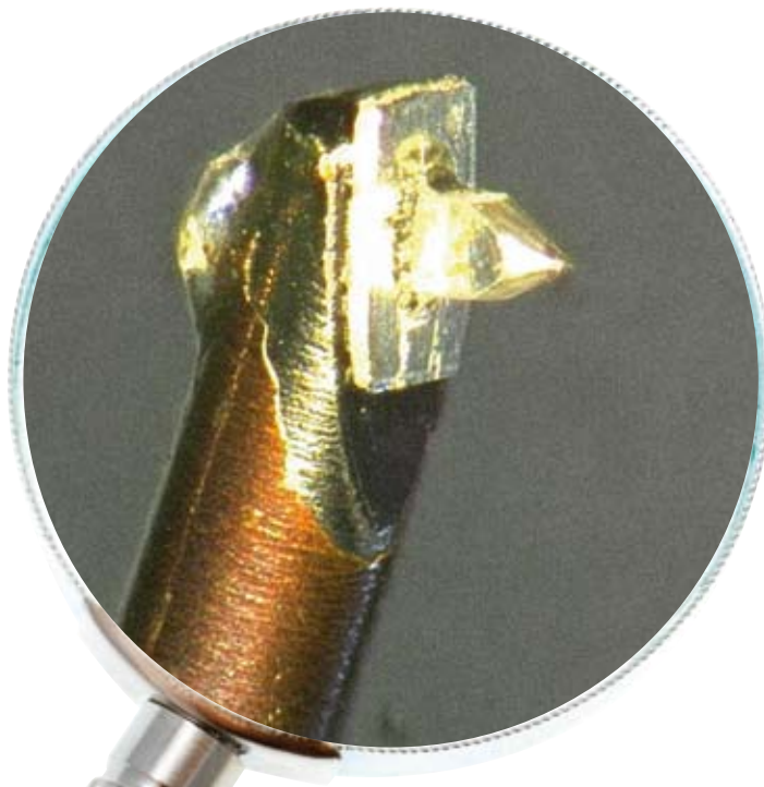
Der feine Diamant-Überzug des Bohr-Röhrchens lässt sich unter dem Mikroskop sehr gut erkennen.
