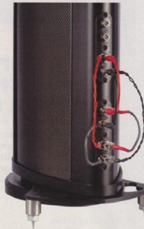
Anschluss über ein Tri-Wiring-Terminal. Die oberen beiden Kontakte senken den Hochtönerpegel um ein oder zwei Dezibel ab
